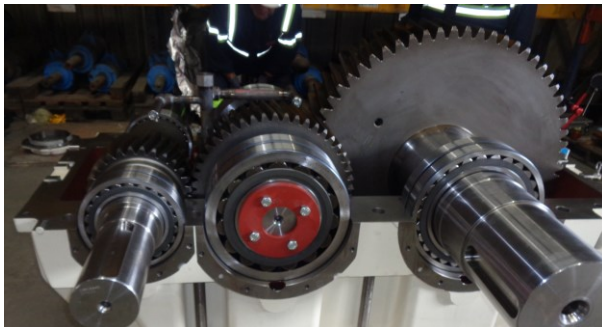
Fig. 5 – Redutor com veios montados para ensaios
