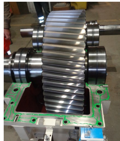
Fig. 8 – Preparação do redutor para fecho da tampa
