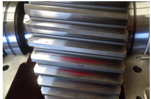
Fig. 6 – Ensaio de contacto dos engrenamentos
