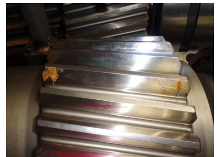
Fig. 4 – Medição de folga “backlash” com recurso a fio de chumbo
