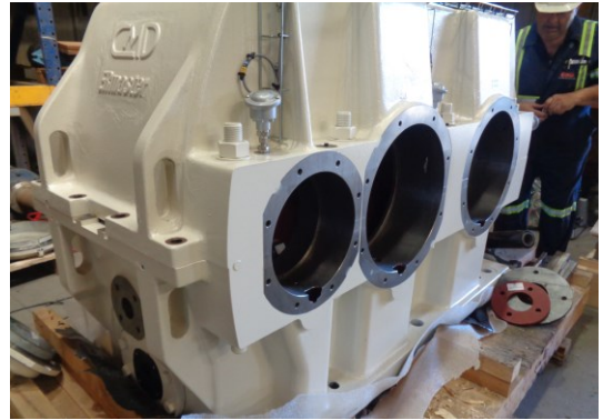
Fig. 1 – Corpo de redutor antes da montagem
